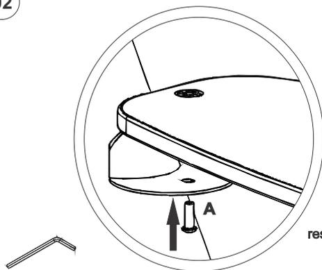
Após fixar a base em madeira, coloque o restante dos parafusos e os aperte totalmente.
