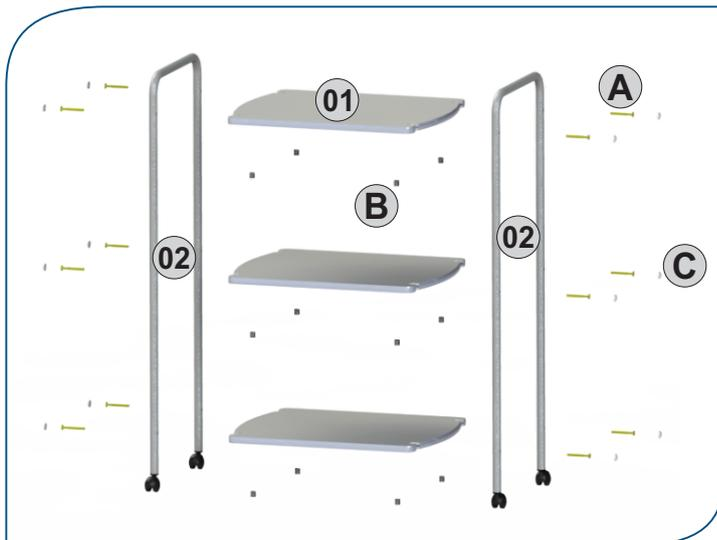
O próximo passo trata-se da montagem das prateleiras utilizando os parafusos **(A)**, porcas cilíndricas **(B)** e as tampas de parafuso **(C)**, como demonstrado na imagem.
