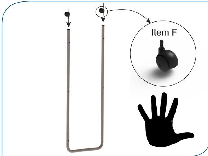
A próxima etapa é a fixação dos rodízios **(F)** nas buchas colocadas no passo anterior, para fixá-los adequadamente deve-se usar apenas as mãos, assim não existe o risco de danificar o componente.
