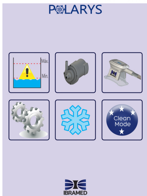
Figura 58. Aviso de que o reservatório de água está abaixo do nível.
