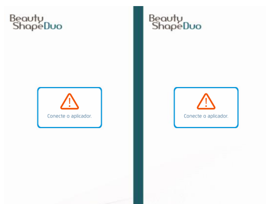
Mensagem exibida quando não existem aplicadores conectados ao equipamento
