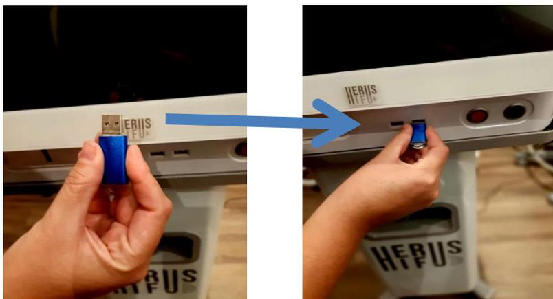
Encaixe o pendrive em qualquer umas das duas entradas USB's na parte da frente do equipamento.
