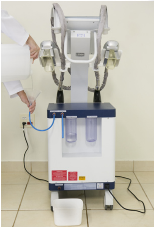
Figura 16. Abastecimento e substituição periódica de água desmineralizada do reservatório do sistema de refrigeração do aplicador.
