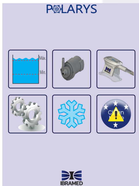
Figura 68. Aviso de procedimento de limpeza não realizado.
