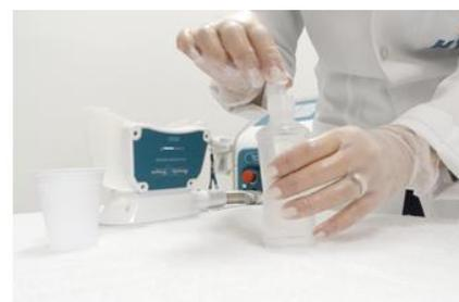
2. Com o aplicador posicionado com o copo para cima, desconecte o protetor de vácuo.
