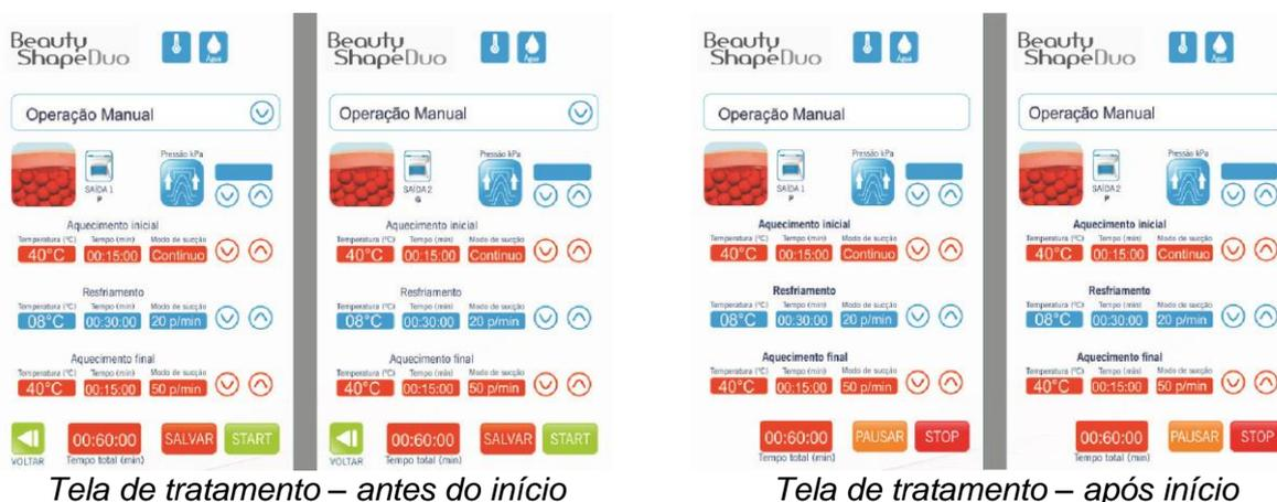
Observe que depois de pressionada a tecla **START**, a mesma muda automaticamente para função **STOP**. Note também que neste momento uma animação é iniciada na parte superior esquerda do display indicando a etapa do tratamento.
