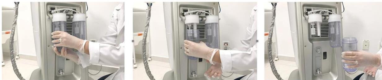
7. Após descartar a água conecte o filtro novamente girando no sentido horário. Rosqueie o filtro até o final para evitar vazamento de vácuo no sistema e mal funcionamento da sucção dos aplicadores.
