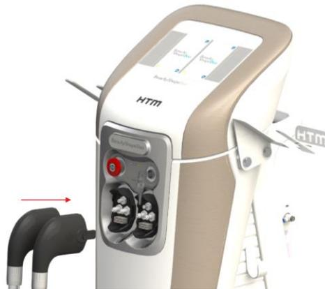
Insira os conectores firmemente até observar um encaixe completo dos contatos elétricos e engates rápidos. Inserir os conectores até escutar um “click”. É necessário apoiar a traseira do equipamento durante o encaixe dos conectores dos aplicadores.
