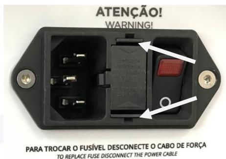
Para fazer a troca do fusível basta remover a tampa do compartimento (vide figura acima). Para isso, é necessário pressionar as abas superior e inferior, conforme a imagem acima, puxando-o para fora. O compartimento contém um fusível 3A reserva para a primeira troca.
