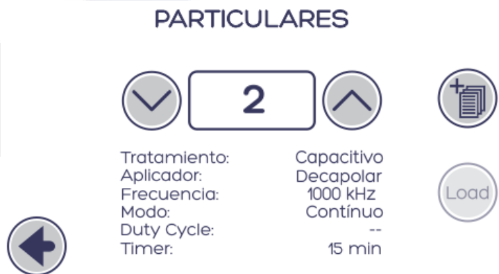
Imagem 33. Tela com o protocolo particular já salvo. Parâmetros salvos diferentes do aplicador conectado ao equipamento.
