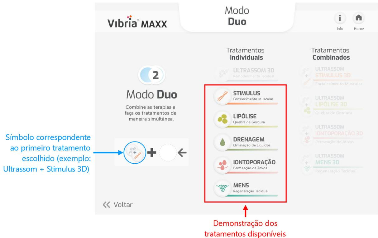
A imagem acima mostra alguns tratamentos não disponíveis para escolha da segunda opção, isso ocorre devido à leitura que o equipamento faz do primeiro tratamento definido, caso seja uma aplicação com corrente bifásica, a segunda automaticamente deve ser uma corrente polarizada e vice-versa.
