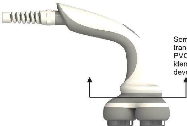
Sempre que for utilizar água para limpeza dos transdutores proteger o aplicador com filme de PVC na parte superior, e limpar a partir do ponto identificado. A parte superior do aplicador nunca deve ser molhada.
