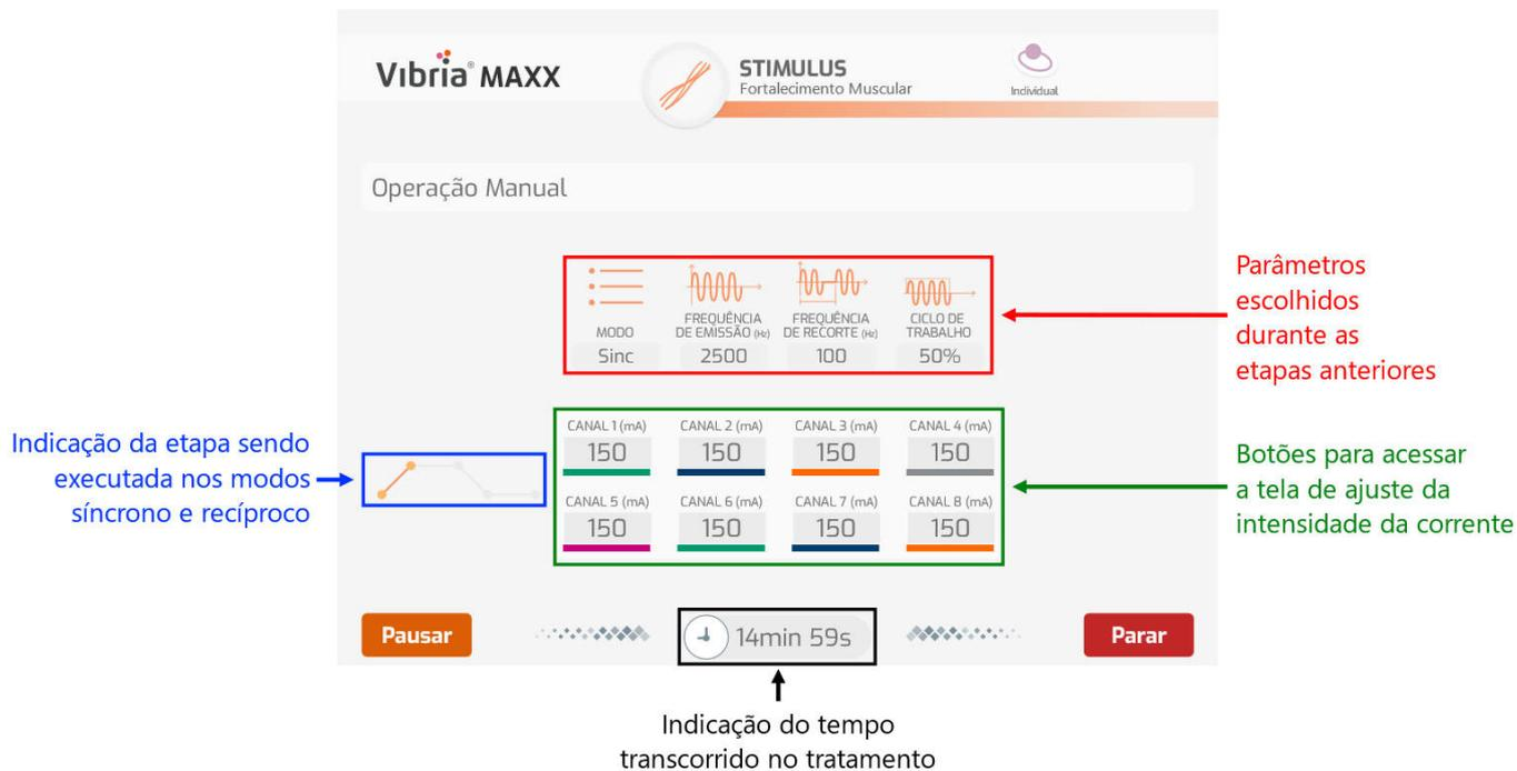
Após pressionar qualquer parte da região onde são demonstradas as intensidades de correntes a tela de ajuste ficará visível, sendo possível alterar os valores de forma individual ou em conjunto através do símbolo
