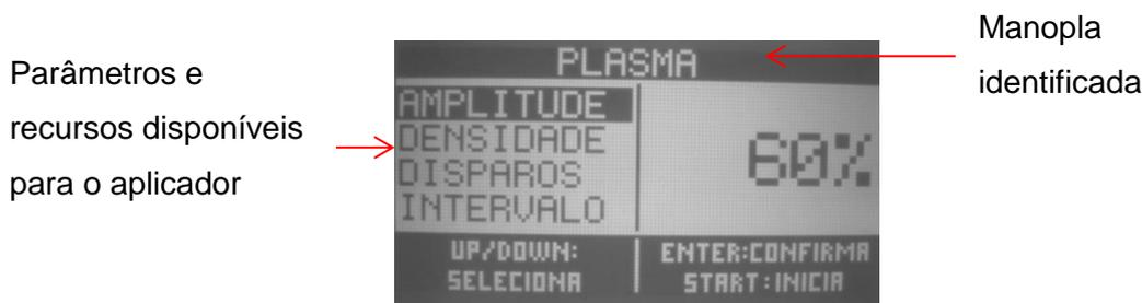
A linha superior mostra a identificação da manopla. Abaixo do lado esquerdo os parâmetros para configurações: **Amplitude, Densidade, modo de Disparos e Intervalo.**
