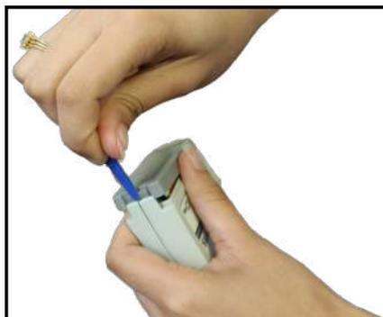
O usuário deve destacar a bateria do conector (1), conectar uma bateria de 9V e encaixá-la novamente no lugar (2).
