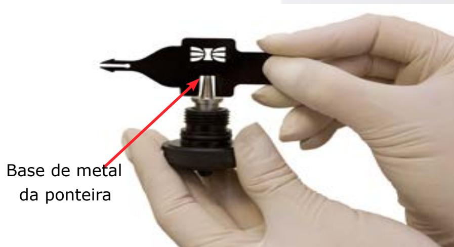
Figura 14. Posicionamento da base de metal da ponteira no gabarito.
