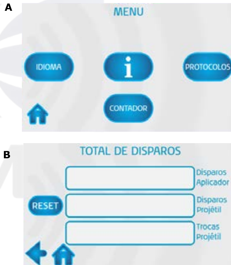
Figura 62. A, tela MENU com a tecla CONTADOR ; B, número total de disparos já realizados com o aplicador e com o projétil.
