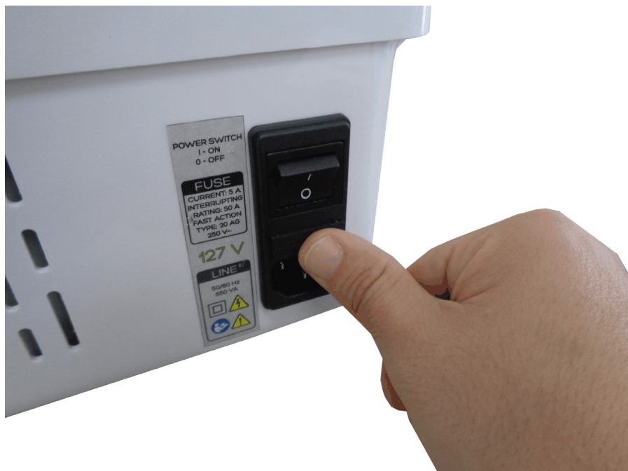
Imagem 17. Reposicionando a gaveta da caixa de fusível.
