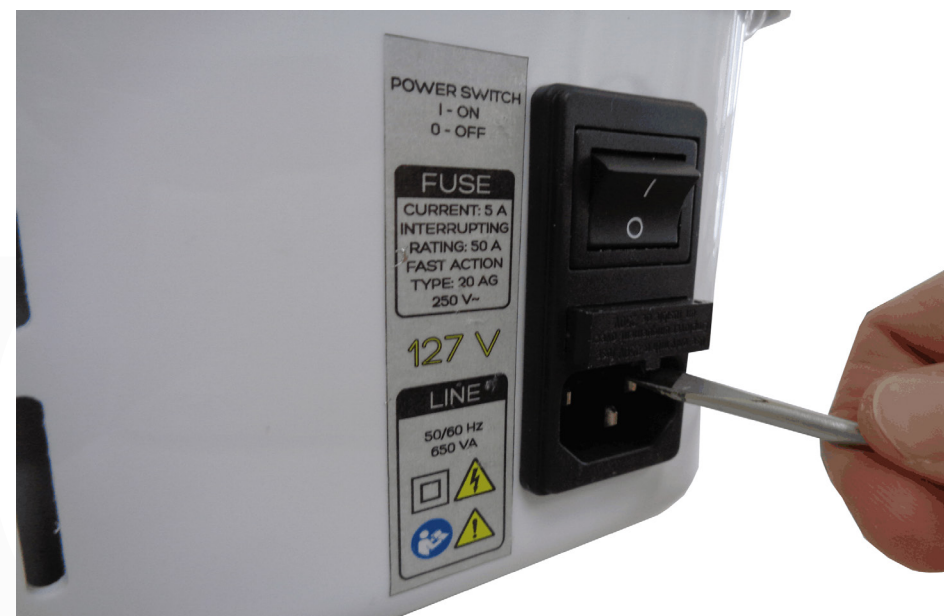
Imagem 16. Removendo a gaveta da caixa de fusível.
