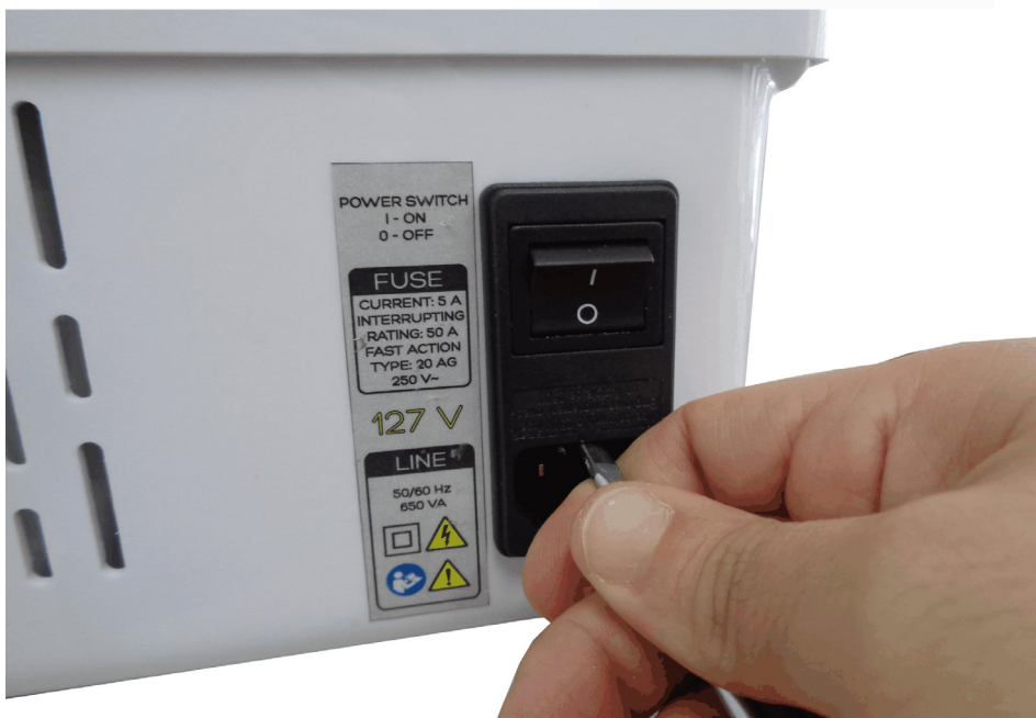
Imagem 15. Abrindo a caixa de fusível.
