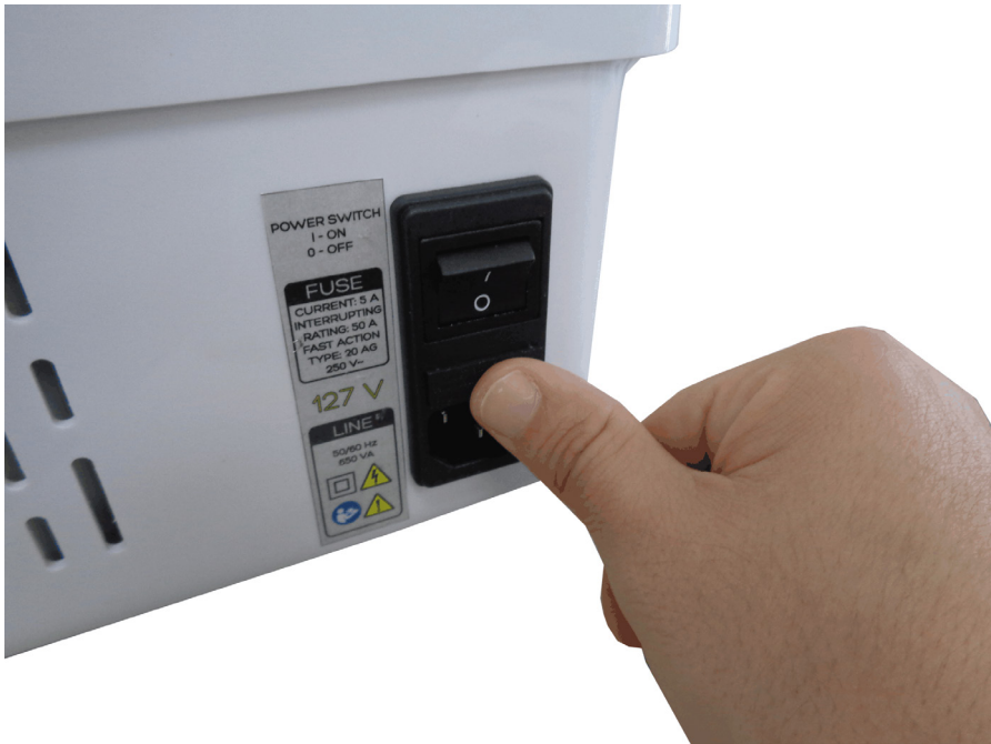
Imagem 17. Reposicionando a gaveta da caixa de fusível.
