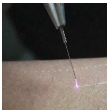
Figura 5: Imagem de um arco de plasma direto a pressão atmosférica produzido com eletrodo de agulha sobre um tecido epitelial vivo. O arco de cor violeta corresponde a um canal de gás atmosférico ionizado (plasma) e conduz corrente elétrica alternada de alta frequência entre a agulha e o tecido produzindo reações químicas e térmicas ao tecido superficial.
