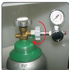
6-Desapertar a válvula.
