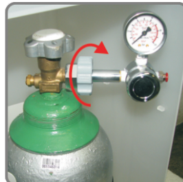
12-Apertar até prender a válvula no cilindro
