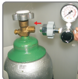
10-Posicionar a válvula
