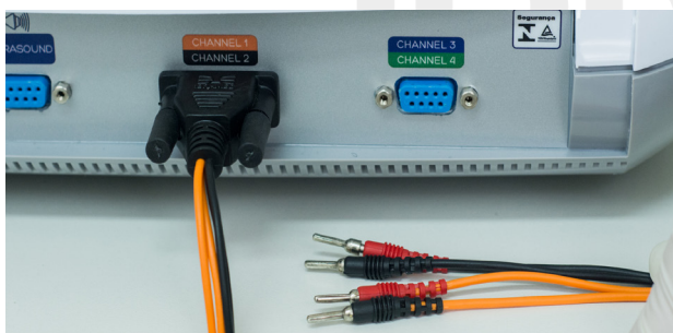
Imagem 33. conexão do cabo de eletroestimulação laranja/preto com extremidades pino banana.
