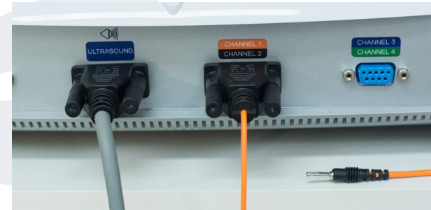
Imagem 30. conexão para a terapia combinada ultrassom + corrente Aussie, Russa, TENS, FES e Interferencial bipolar.
