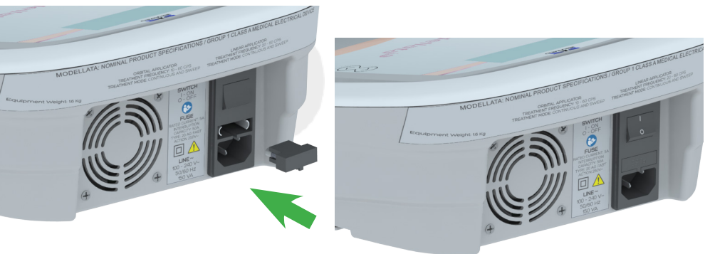
Imagem 31. A, Removendo a tampa protetora e a gaveta dos fusíveis; B, substituindo os fusíveis de proteção; e C, reposicionando a gaveta dos fusíveis.
