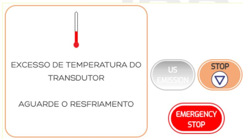
Após o resfriamento do transdutor o equipamento retorna a tela de execução, porém com a **emissão pausada**, para evitar riscos de segurança.
