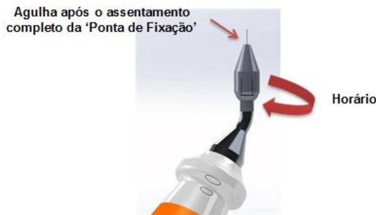
**Passo 5:** Para substituição da agulha, é necessário apenas remover a 'ponta de fixação' girando-a no sentido anti-horário. Retire a agulha a faça o seu descarte corretamente antes de instalar uma nova agulha. Siga os passos anteriores para reinstalação da 'Ponta de Fixação'.
