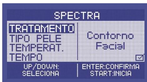
A linha superior mostra a identificação do equipamento. Abaixo há seis campos para configurações, mas apenas os campos Tratamento, Tipo de Pele e Amplitude permitem ajustes.
