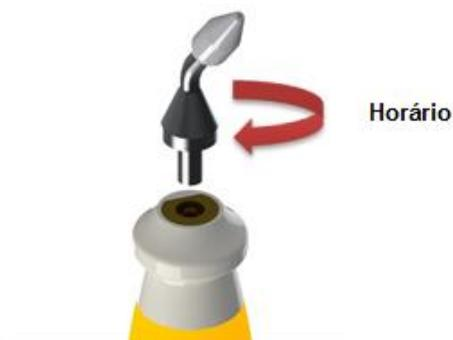
**Passo 2:** Remova a 'ponta de fixação' girando-a em sentido anti-horário para possibilitar a instalação da agulha. Veja figura abaixo.
