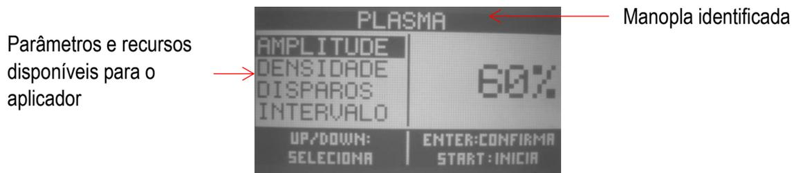
A linha superior mostra a identificação da manopla. Abaixo do lado esquerdo os parâmetros para configurações: **Amplitude, Densidade, modo de Disparos e Intervalo.**
