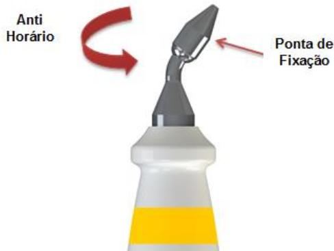
**Passo 3:** Insira a base espiralada da agulha no orifício da 'ponteira base'. Encaixe a 'Ponta de Fixação' sobre a agulha até que esta saia pelo orifício da 'Ponta de Fixação'. Gire a 'Ponta de Fixação' no sentido horário até o assentamento completo e a fixação segura da agulha. Veja a figura abaixo.
