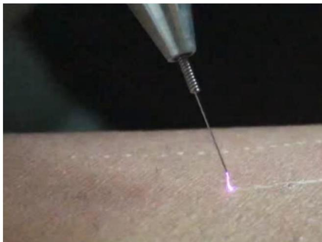
Imagem de um arco de plasma direto a pressão atmosférica produzido com eletrodo pontiagudo sobre um tecido epitelial vivo. O arco de cor violeta corresponde a um canal de gás atmosférico ionizado (plasma) e conduz corrente elétrica alternada de alta frequência entre o eletrodo e o tecido, produzindo neste reações químicas e térmicas.
