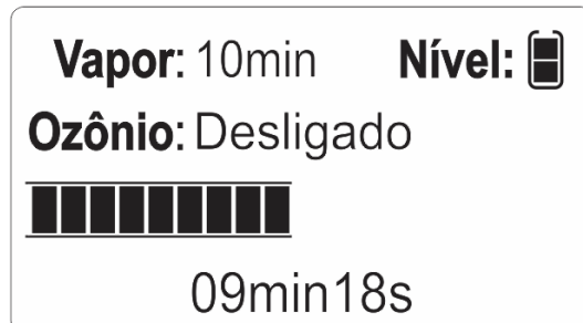
Telas de indicação do aquecimento da água e do tempo decorrido do tratamento para o Beauty Steam MAXX
