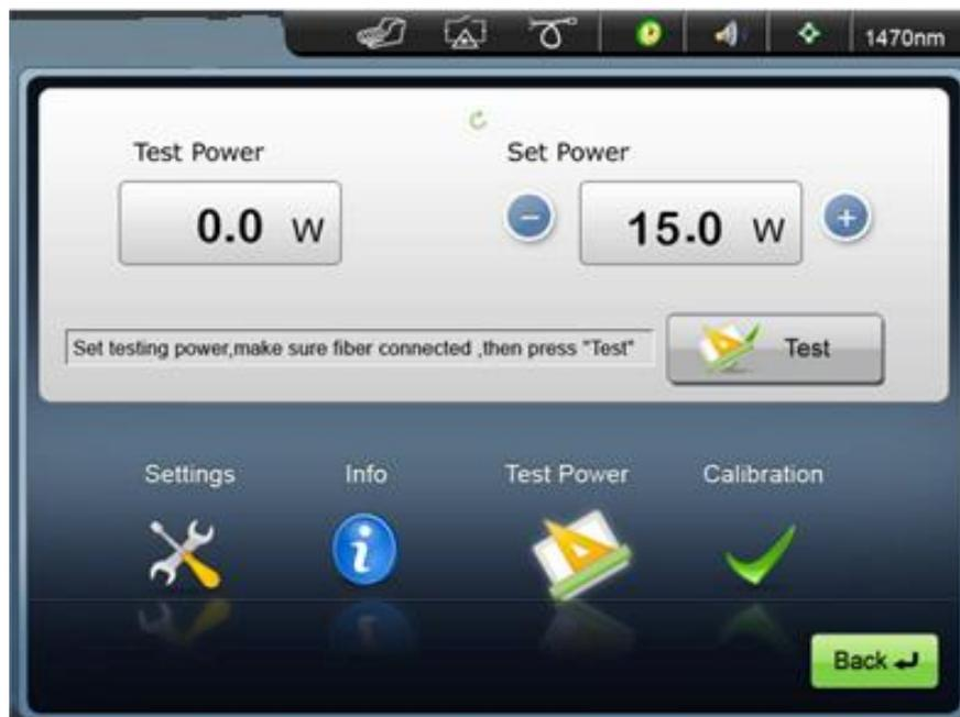
Ao pressionar o botão “Test Power”, você entrará na interface de teste de energia. Escolha o comprimento de onda que deseja testar clicando no botão de comprimento de onda correspondente.
