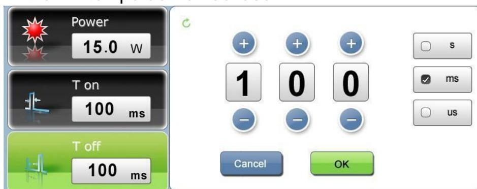
O tempo Toff é o tempo de desligamento do laser durante um período de pulso. Varia de 10 $\mu$ s a 10s. Ao pressionar o botão “+” e “-”, você pode ajustar o valor convenientemente. Além disso, você pode usar o botão de codificação para ajustar. Ao finalizar, “INN LASER-15D” salvará o parâmetro na proposta.
