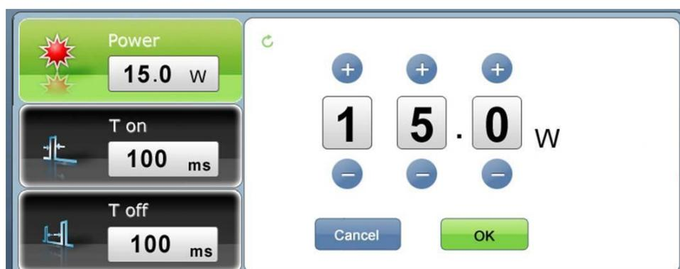
A potência de pico é a potência MAX de saída ao emitir laser e o intervalo é de 1W a 15W. Ao pressionar o botão “+” e “-”, você pode definir a potência de saída do laser de forma conveniente. Além disso, você pode usar o botão de codificação para ajustá-lo. Ao finalizar o ajuste, “INN LASER-15D” salvará o parâmetro na proposta.
