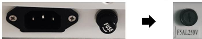
FIGURA 10. DIAGRAMA ESQUEMÁTICO DE SUBSTITUIÇÃO DO FUSÍVEL
