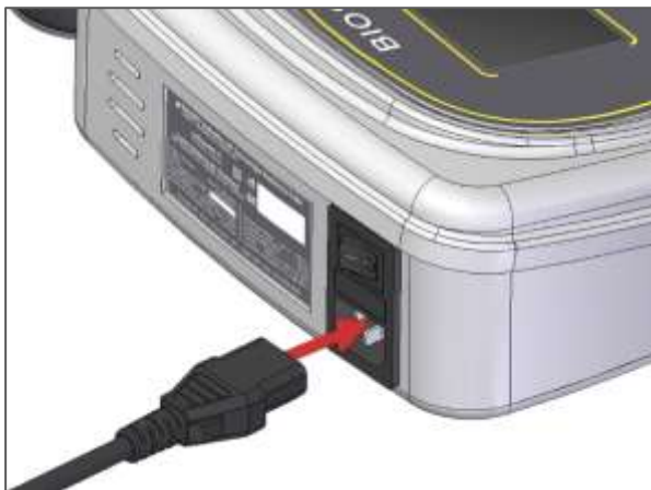
Conexão do Cabo de alimentação
