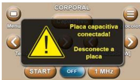
Quando este aviso aparecer em seu visor verifique se a placa capacitiva está plugada no equipamento durante a aplicação BIPOLAR. Caso estiver, desconecte-a.
