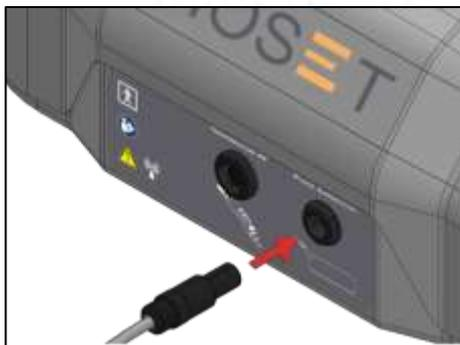
*Conexão da Placa Capacitiva*
