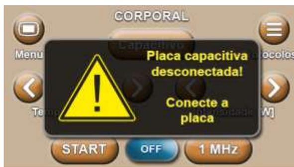
Quando este aviso aparecer em seu visor verifique se a placa capacitiva está plugada no equipamento e se o conector está bem fixado.
