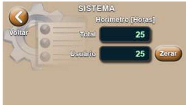
Horímetro Total: Mostra quantas horas a saída de Placas de LED ficou em funcionamento.
