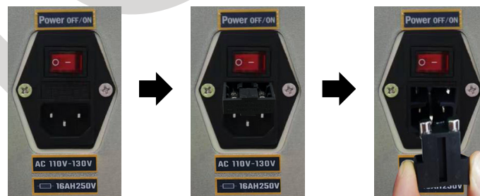
FIGURA 11. DIAGRAMA ESQUEMÁTICO DE SUBSTITUIÇÃO DO FUSÍVEL
