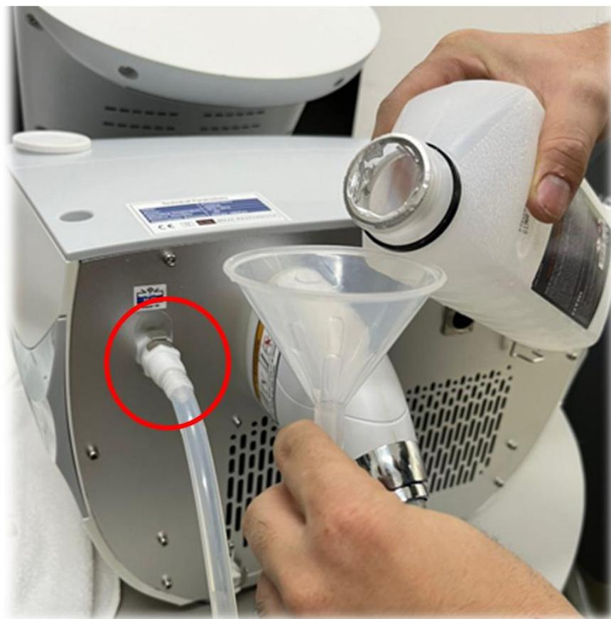
Adicione água desmineralizada até que a água comece a sair pelo respiro, indicando que o reservatório está cheio. Deixe o plugue do respiro e o funil conectados para facilitar a adição de mais água posteriormente. Ligue o equipamento por 2 minutos. Em seguida, desligue o equipamento.
