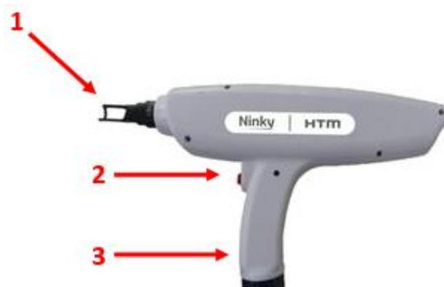
**1 – Ponta:** 3 diferentes pontas podem ser rosqueadas no aplicador para serem utilizadas, sendo: 532 nm, 1064nm e 1320 nm.
