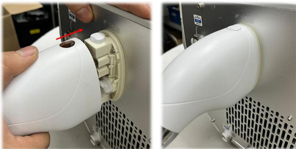
**3)** Remova a proteção da ponta do aplicador a laser e guarde. Rosqueie a ponteira escolhida. Ao terminar a aplicação, guarde a ponteira e coloque novamente a proteção da ponta do aplicador.
