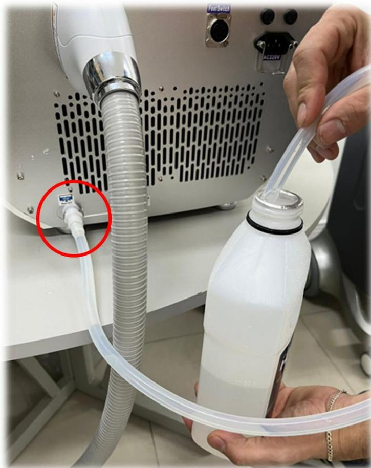
O sistema de resfriamento é preenchido com água desmineralizada para prolongar a vida do cristal de YAG do aplicador a LASER. O tanque interno tem a capacidade de 2,5 litros de água. Ao r
